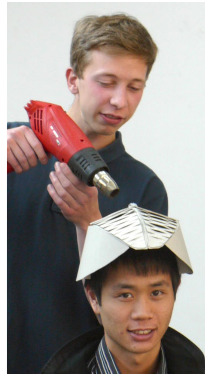
Radhelm mit Elastomergrill, der sich bei Temperaturanstieg mittels FGL-Feder öffnet.
